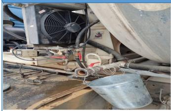
Перед разгрузкой бетона из автобетоновоза в емкость для приема бетона, водитель автобетоновоза решил проверить спуск воды из накопительного бака. В ходе осмотра работник обнаружил, что вода в спускном резиновом шланге замерзла, и он принял решение отсоединить шланг, идущий от бака с водой до патрубка с краном и прогревать его горелкой.
